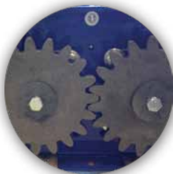
Kugghjul med direkt-drift för säker körning.
