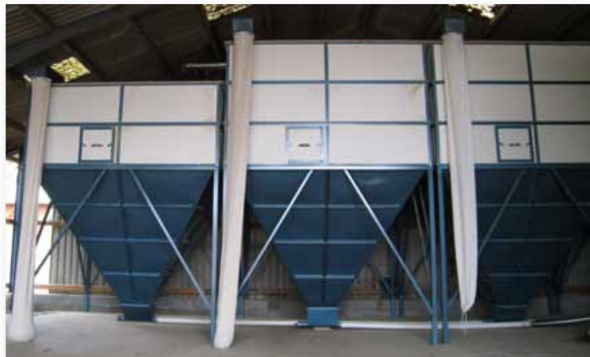
Tre stycken silos, utrustade med melaminskivor, avluftning med filterstrumpa samt anslutning till flexskruv.
